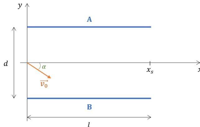
Des électrons entrent avec une vitesse initiale  $\vec{v}_0$  de norme  $2,5 \times 10^6$  m/s entre les plaques chargées d'un condensateur plan. Le vecteur vitesse fait un angle de  $30^\circ$  avec l'axe  $x$  comme indiqué sur la figure et l'expérience se fait dans le vide. Les plaques A et B ont une longueur de  $l = 6$  cm et sont distantes de  $d = 4$  cm. Le réglage de la tension  $U_{AB}$  permet de faire varier l'ordonnée du point S où les électrons sortent du champ électrique.
