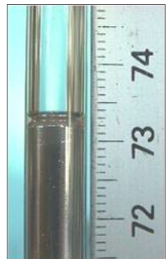
le baromètre à mercure mesure la pression atmosphérique de façon précise
