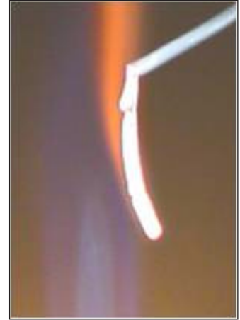
un fil en aluminium chauffé jusqu'à fusion se plie sans que le métal liquide ne s'écoule
