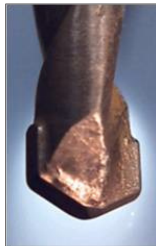
foret « Widia » utilisé pour percer la pierre
