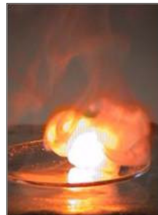
le sodium brûle sur un papier filtre sur l'eau
