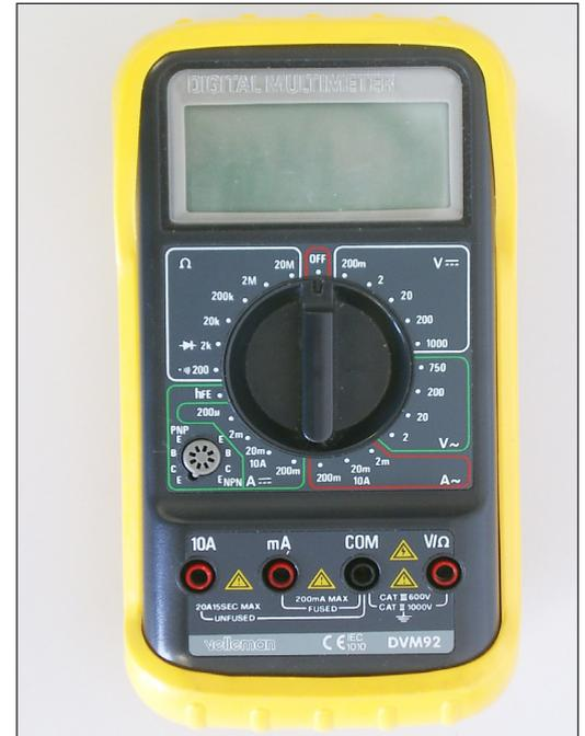
Fig. 2 : Photo d'un multimètre (à affichage digital)
