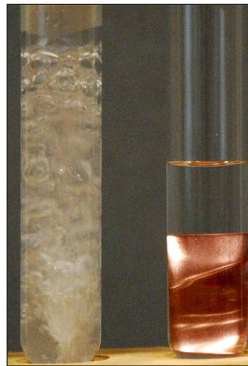
zinc + acide chlorhydrique (à gauche), cuivre + acide chlorhydrique (à droite)
