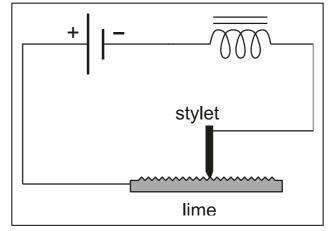
l'intensité de courant diminue brusquement et la bobine est le siège d'une f.é.m. d'autoinduction élevée. Ainsi il apparaît une tension élevée entre les bornes de l'interrupteur. L'air y devient conducteur et une étincelle jaillit : l'énergie magnétique initialement emmagasinée par la bobine y est libérée.
