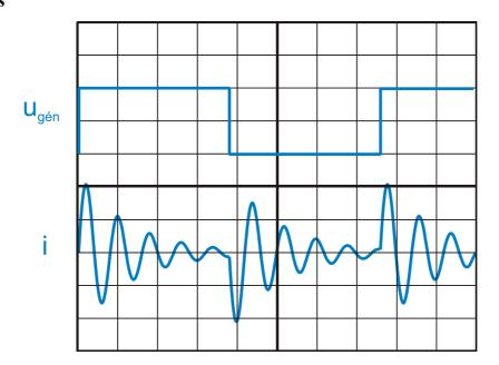
Le circuit RLC est le siège d'oscillations électriques amorties!
